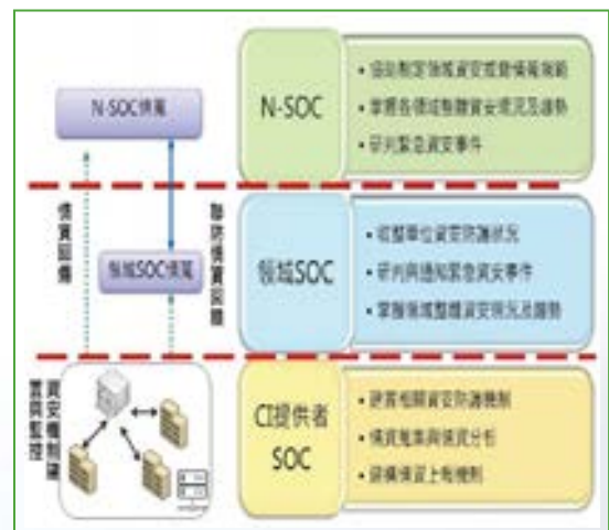
圖 壹-38 國家層級N-SOC與領域層級SOC透過STIX格式進行資料交換示意圖
